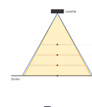
Ausleuchtung (Richtwert) 7055S6 - ARIS 10W/4000K/10 - 1000 lx Höhenwerte 27° (300 lx) / 30° (200 lx)
